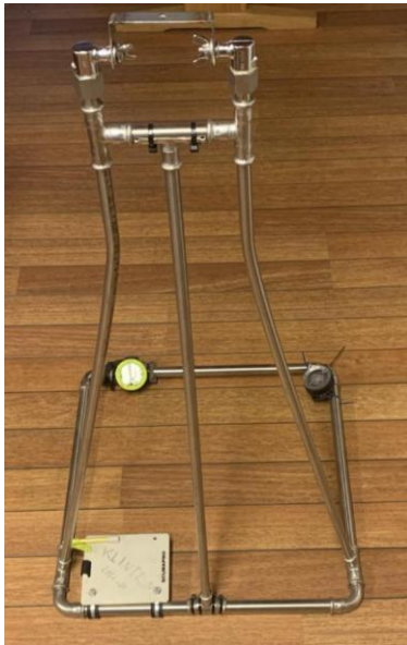
Figur 1: Rammekonstruktion til anvendelse i billedindsamling, Til venstre ses rammen for sig selv, til højre ses rammen sammen med operatør under dataindsamling. Rammen indeholder kompas, dybdemåler og plade til at notere lokation af hvert enkelt billede. Fotos: Møns sportsdykkerklub.
