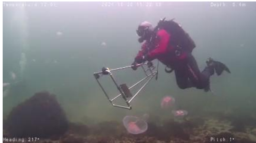
Figur 1: Rammekonstruktion til anvendelse i billedindsamling, Til venstre ses rammen for sig selv, til højre ses rammen sammen med operatør under dataindsamling. Rammen indeholder kompas, dybdemåler og plade til at notere lokation af hvert enkelt billede. Fotos: Møns sportsdykkerklub.
